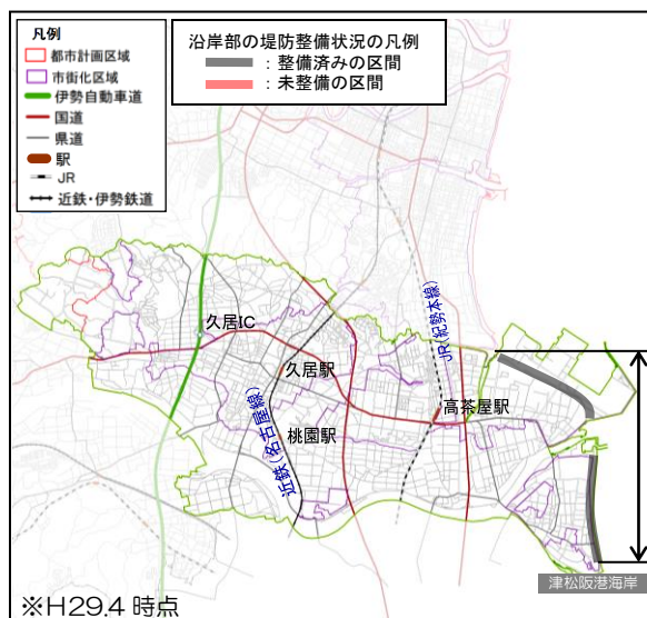
■堤防整備の状況
