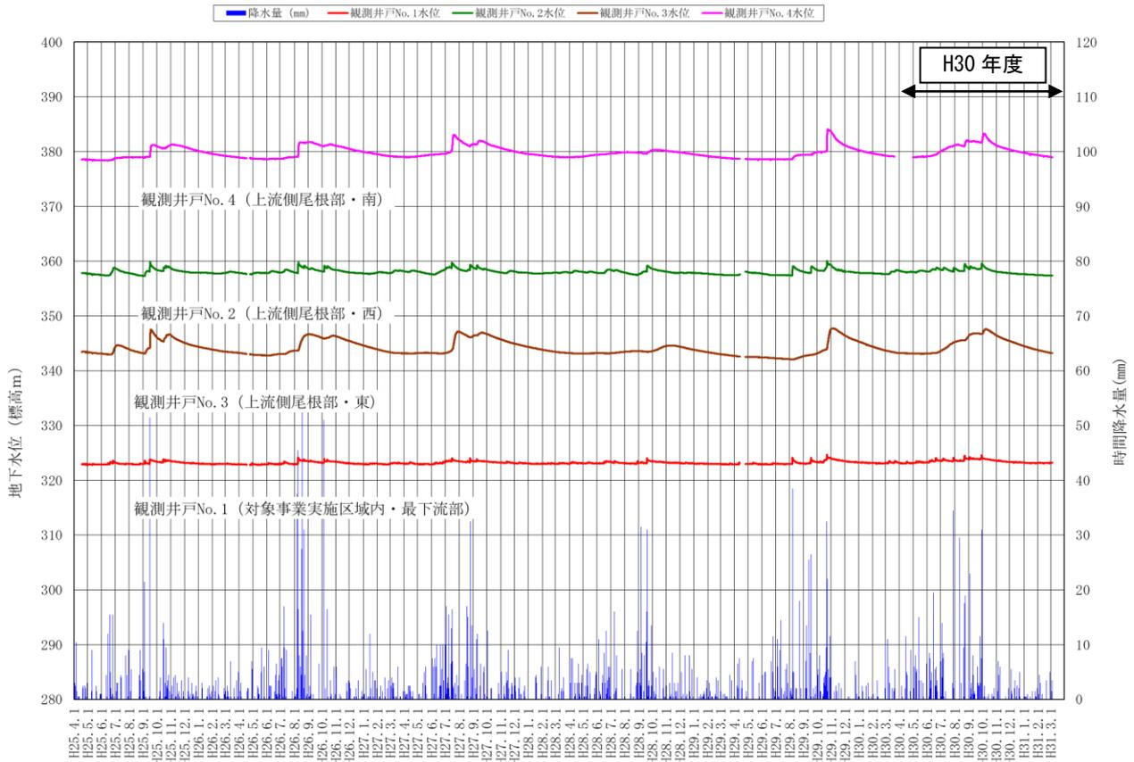
注) 観測井戸 No. 4 の平成 30 年 3 月 20 日～5 月 1 日のデータは、5 月 1 日の自記水位計入替時に、既設の自記水位計が観測井戸内に落下していたため欠測となった。
