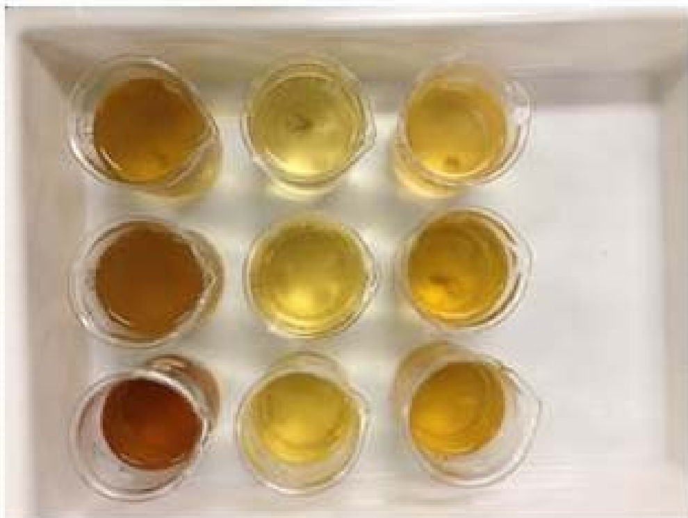
写真-6 初期浸出水 (左から未洗浄、洗浄液固比 0.5、洗浄液固比 1.0)
