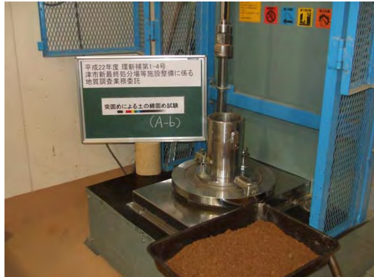
突固めによる土の締固め試験 (A-b)
