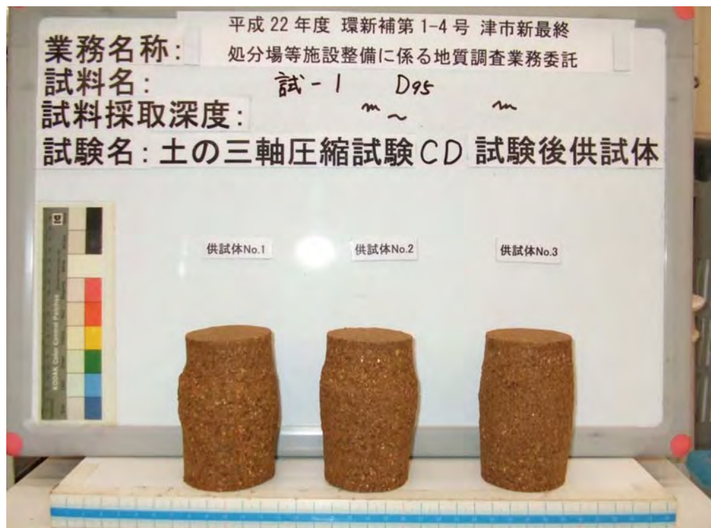
試-1 D95 土の三軸圧縮試験(CD) 試験後供試体
