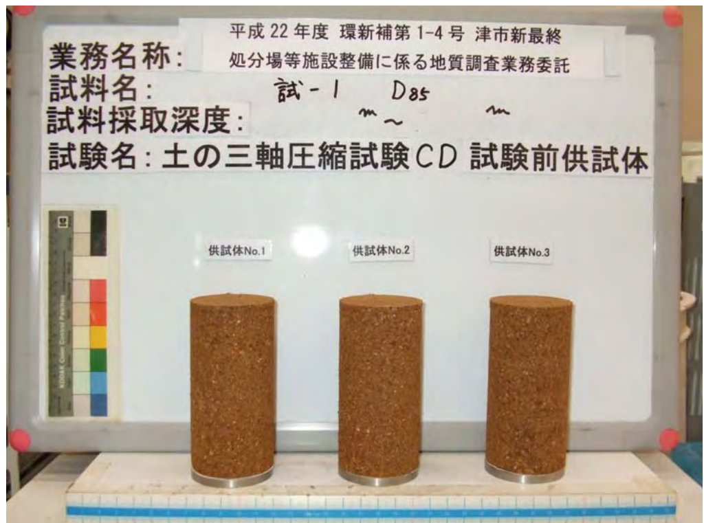
試-1 D85 土の三軸圧縮試験(CD) 試験前供試体
