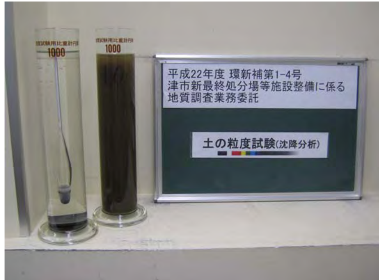
土の粒度試験（沈降分析）
