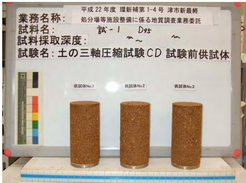
試-1 D95 土の三軸圧縮試験(CD) 試験前供試体
