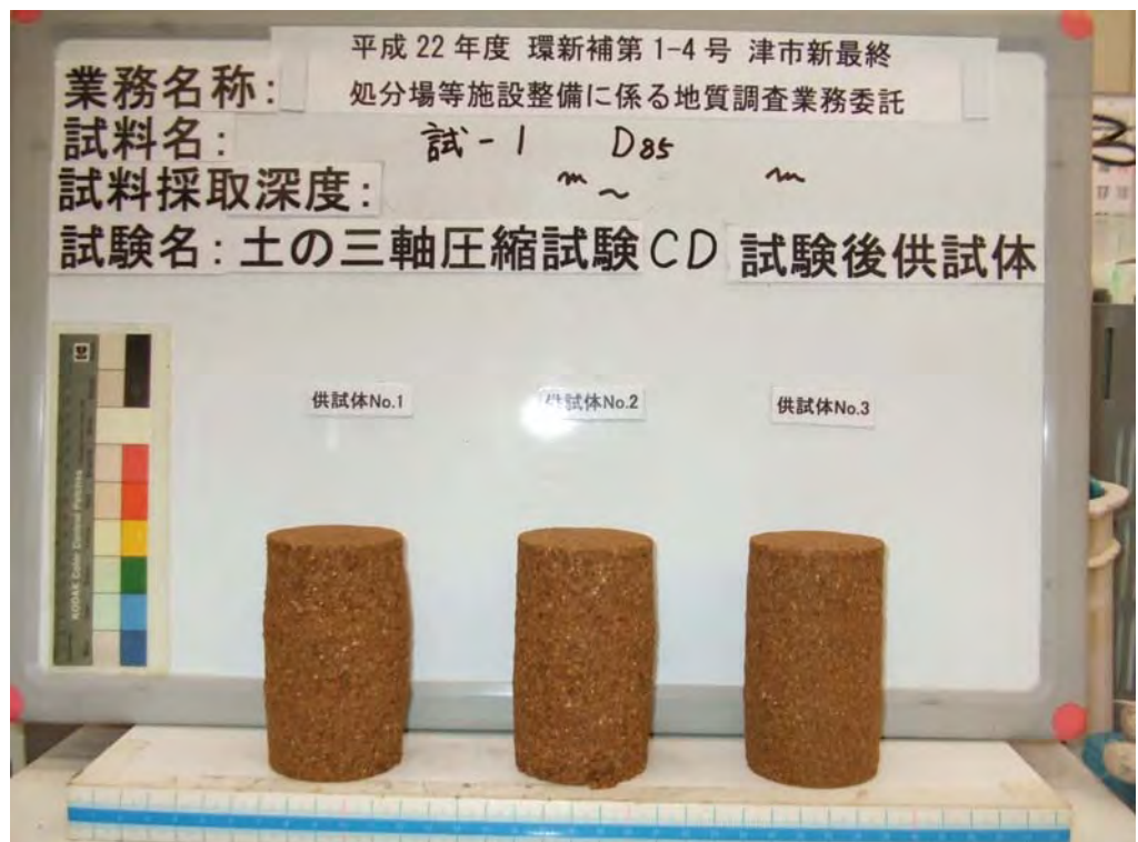
試-1 D85 土の三軸圧縮試験(CD) 試験後供試体
