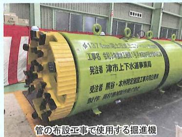
管の布設工事で使用する掘進機
