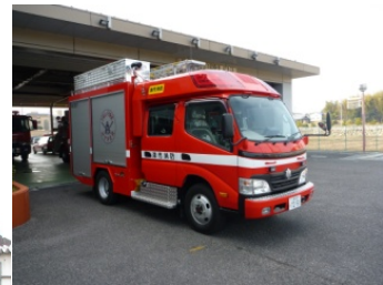
↑久居消防署に導入された圧縮空気泡消火装置積載車
