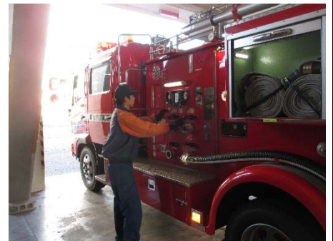
↑ポンプの点検
