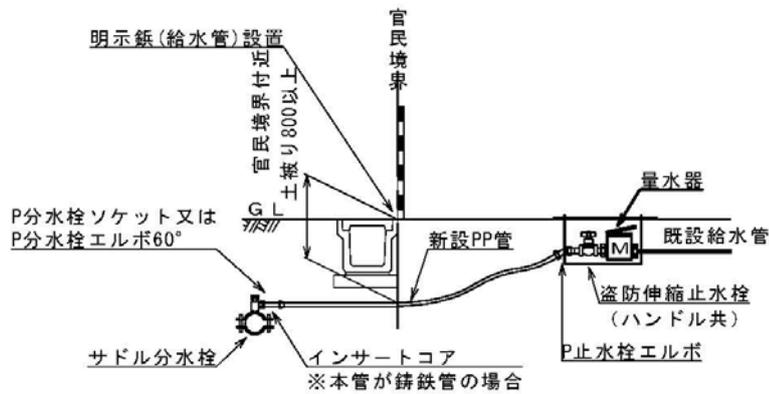
給水管口径  $\phi 30\text{mm}$ 以上
