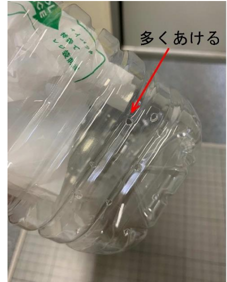
⑮ ⑤を固定するよう⑭を使って留める ⑯ 水抜き穴を開ける
