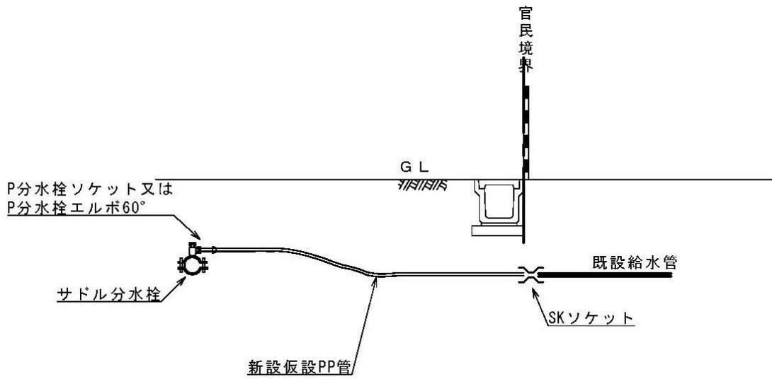
給水管口径  $\phi 30\text{mm}$  以上
