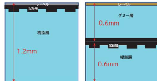
CD盤断面図 DVD盤断面図
