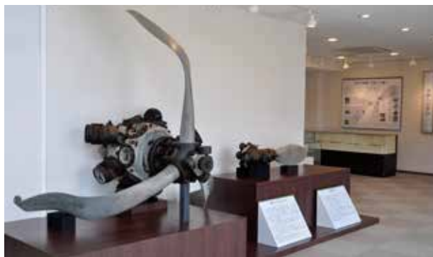
プロペラが曲がった状態の零戦エンジン(左側)
