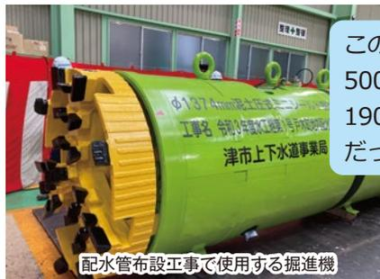
この掘進機で口径500mmの配水管を190mも布設するんだって。
