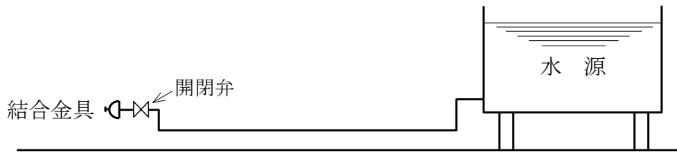
第18-1図 a 地上式の水源を有する消防用水
