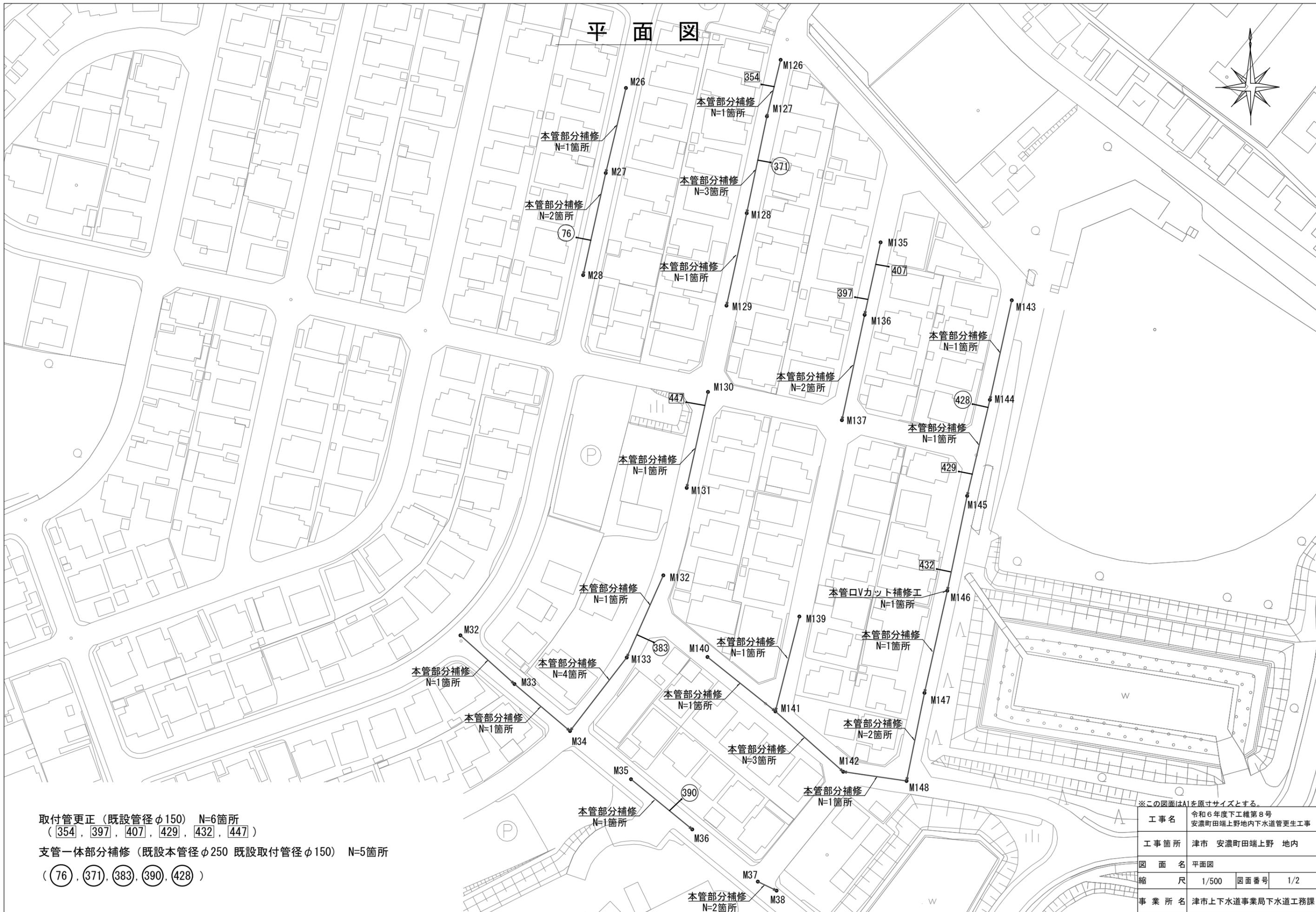
取付管更正 (既設管径φ150) N=6箇所
