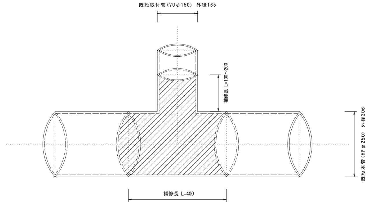
本管口Vカット補修工
