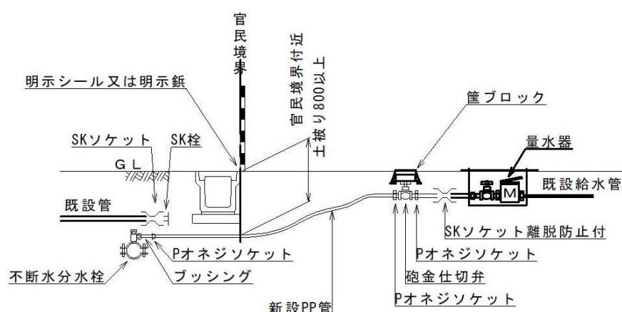
給水管口径  $\phi 25\text{mm}$ 以下
