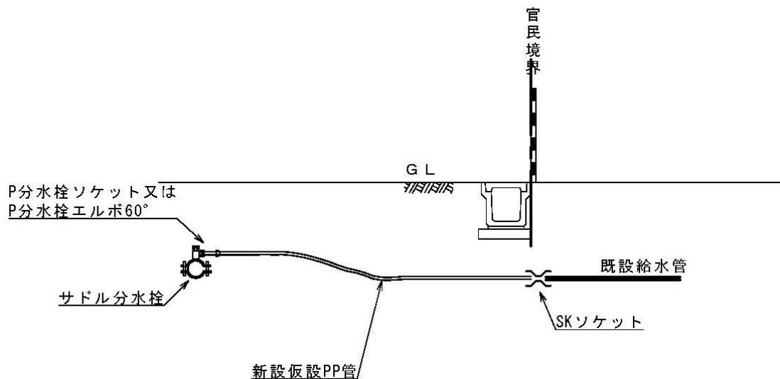
給水管口径  $\phi 30\text{mm}$ 以上
