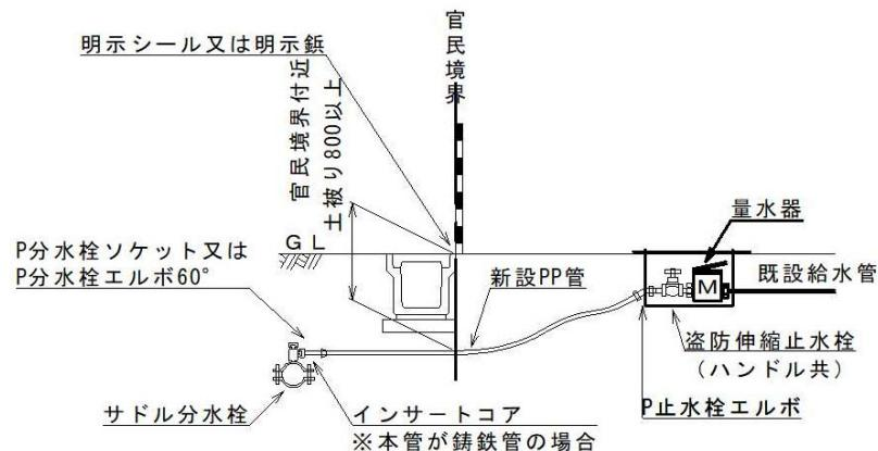
給水管口径  $\phi 30\text{mm}$ 以上
