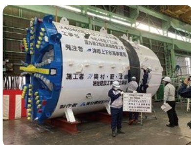
管径3.4mの雨水管を築造したシールドマシン
