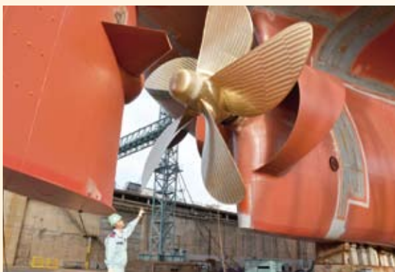
直径8mもあるプロペラで20万トン以上の船体を推進する
